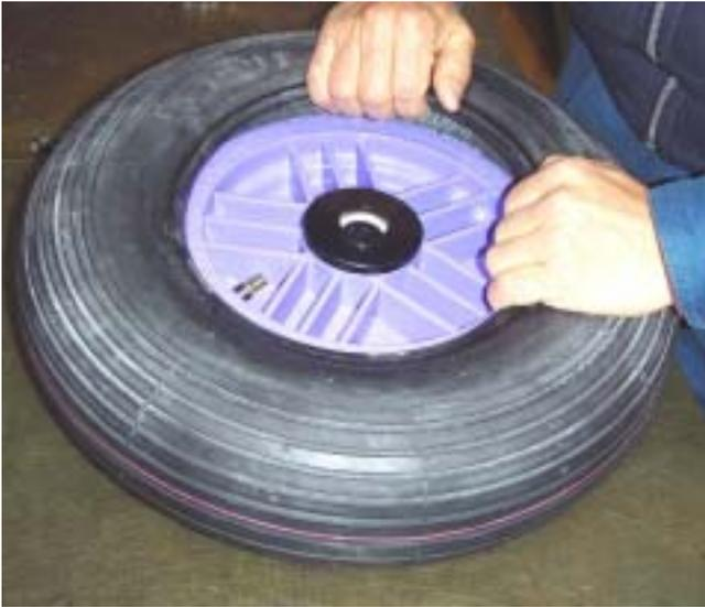
専用工具を外しタイヤ全体を両手で引き出します。
