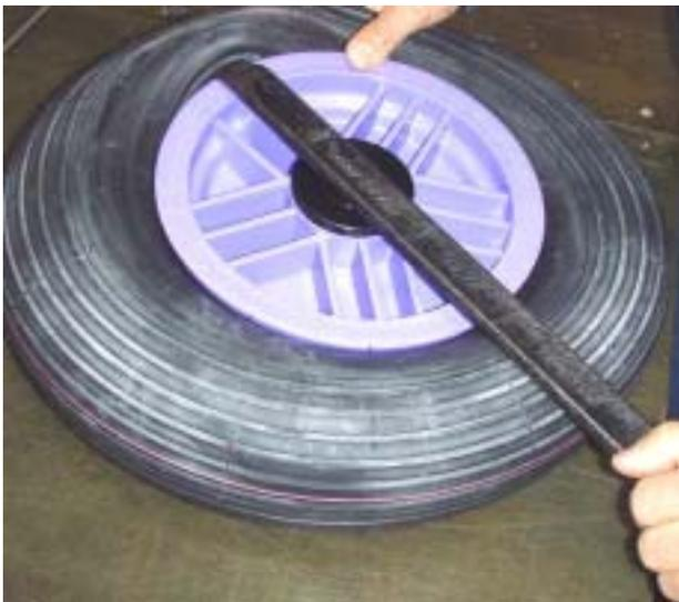
専用工具(ホームセンター、タイヤ屋、さん等でお求め下さい)で一箇所のタイヤ外側を引き出します。
