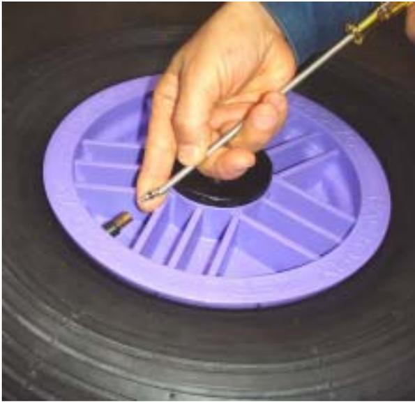
チューブのバルブから中のムシ部分を抜き出します。専用工具(先端に溝が着いているドライバー)が必要です。
