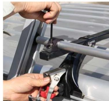
③フロントロックアッセンブリも外れますので同時に外し保管します（ネジ緩めると金具は脱落しますので片手で保持下さい）
