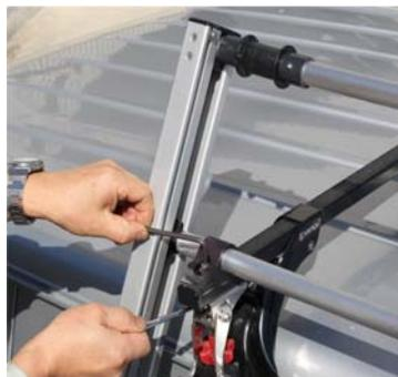
②商品付随の工具（六角レンチとスパナ）で写真の軸止ブラケットを外します。サドル（黒いプラスチックのベース）も外れますので全て保管します
