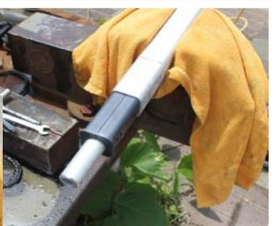
差し込んだプラカラーにシャフトを叩き込みボルトで仮固定
