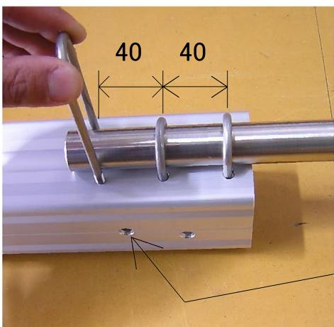
新たにステンレス車軸を取り付ける際にUボルトを1個内側に追加します。
