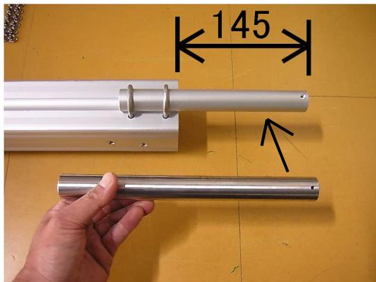
既存のシャフトを外しステンレス強化車軸を取り付けます。
