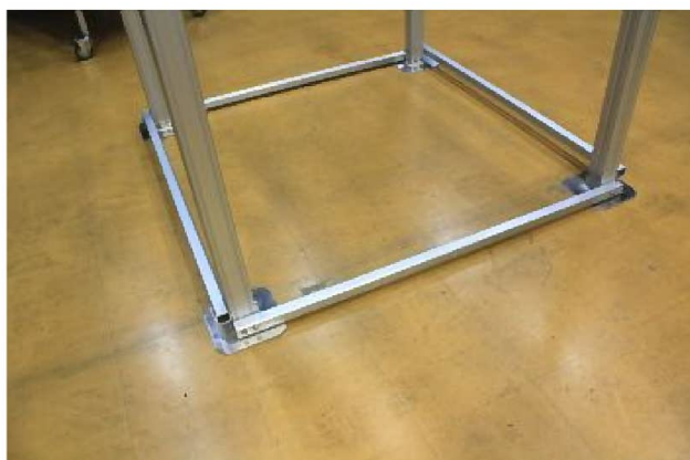
柱開き止めフレーム組立完成写真
