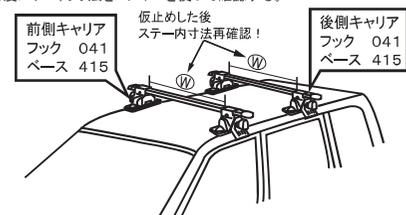
1 選択したキャリア取付位置の車両ブラケット（ルーフ上面）にフックを上から差し込み、ブラケットにフックを引っ掛ける。
