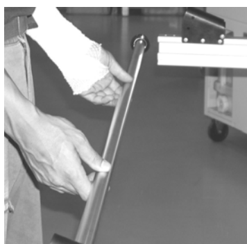
ベアリング用連結パイプも外して交換します
