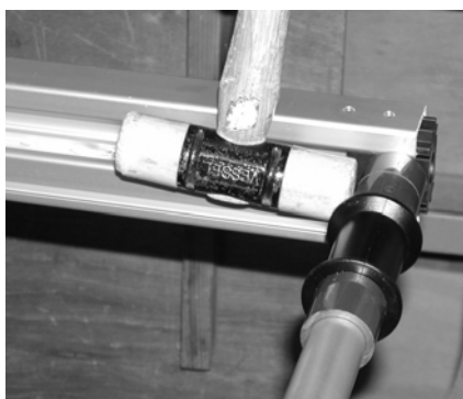
反対側のガイドローラーパイプも同様 に叩いて外します
