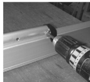
＋皿M5mmx10mmのネジをネジ込ます(タッピングでも良いです)
