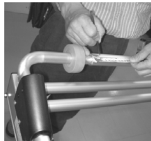
取って固定用リボットの穴アケ位置(パイプ端から20mm)をマークします
