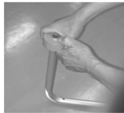
ハンドルローラーを入れます(シリコンを塗布すると入れやすい)
