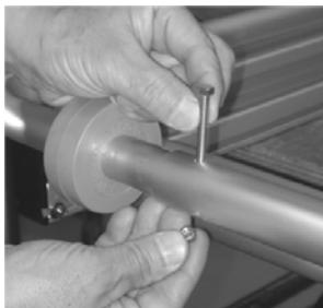
リボット止めが出来ない方はボルト(ネジ)+ナット固定でも問題ありません(M5mmx40mm長さ)
