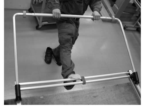
バー全体を写真のように引き抜いてハンドルエンドガイドハンドルを外すことも出来ます
