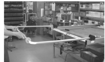
取ってパイプとハンドルジョイントパイプを組み込みながらオーバースライダー本体に差し込みます(平行に差し込んで下さい)
