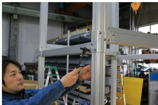
支柱に連結フレームを六角ボルト8-90 ワッシャー、フランジナットセレート付 で取付ます。
