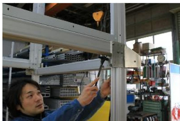
支柱に連結フレームを六角ボルト8-90 ワッシャー、フランジナットセレート付 で取付ます。
