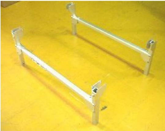
四方に並べたフットパイプの中間のジョイントブラケットAに側面フレームをトラスM8-60類で固定します。
