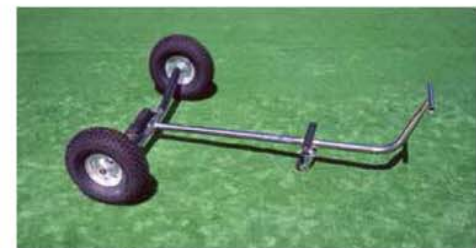
最初に製作されたPWC用の船台。アルミではなくステンレス製で、形状も現行モデルとは異なり大型。
