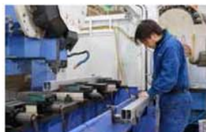
ジェットランチャーの製作にも使用するマシンニングセンター。この機械で穴開けや切削などの加工を行っている。
