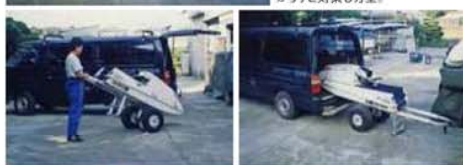
ジェットランチャー開発時の貴重な写真がこちら。運搬時の軽快感、トラクションへの伝わり感など、細かいテストが繰り返された。タイヤのホイールをプラスチック、ヘアリングを樹脂にするなど、当初からサビ対策も万全。
