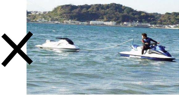
●バナナボート、ビスケツ、ジェット等ウェイクボード以外は絶対にトローイングしないでください、破損の原因になります。
