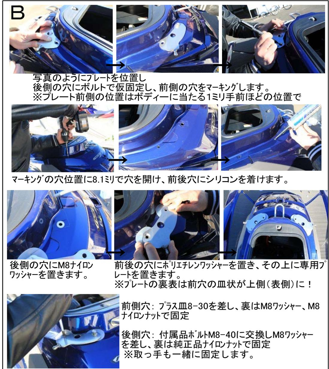
艇体取付パーツですので使用している間にネジ、ボルト等のゆるみが生じ、そのまま使用しますと艇体にヒビがはいりますので必ず点検し、ゆるんだ際は増し締めをしてください。
