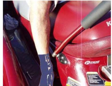
●サイドパイプ式ではトローイング中クイックカブラーに触れないよう注意してください、万一カブラーが外れますと艇体が壊れる恐れがあります。
