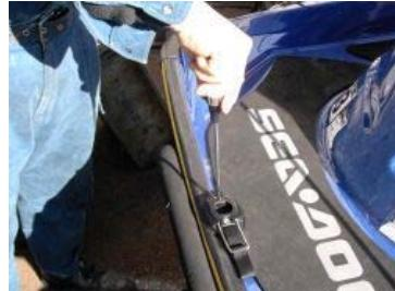
●艇体側各取付部にガタツキが生じた場合は即座にトeingを中止しボルト、ナット等の増し締めをしてください、そのまま使用しますと破損の原因になります。
