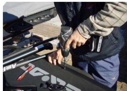
ドリル(刃6.1ミリ)で穴を開け、回りのバリを取り除き連結ボウルベースを上から皿ビス、下からM6ワッシャー、M6ナイロンナットで締めます。
