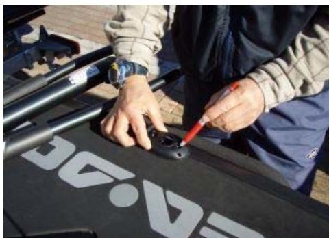
連結ボウル着脱ベースプレート取付箇所の艇体内側にビスが出てナットを締めることができる位置を確認しまー킹します。
