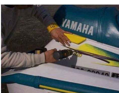
左右のマーキングに下穴3~4ミリ開けてからドリル(刃8.1ミリ)で穴を開け、回りのバリを取り除きます
