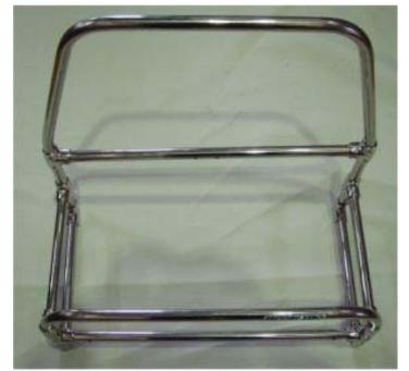
**C** <後フレームとタワーフレームを組み合わせる>
