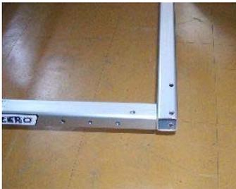
前後フレームと左右フレームを写真のように合わせます。
