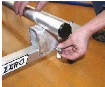
レールパイプの穴と左右フレームの穴を合わせM8ワッシャー、ボルト8-60を差し反対からM8ワッシャー、スプリングワッシャー、ナットにて締めます。
