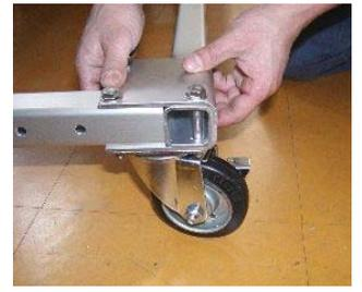
コーナーブラケットの下にキャスターを付けM8ワッシャー、スプリングワッシャー、ナットにて仮締めし、その他のコーナーも同様に組みます。
