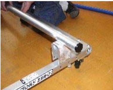
四角に組み立てられたフレームにレールパイプを差込みます。
