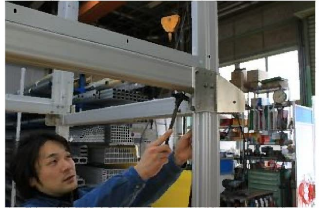
支柱に連結フレームを六角ボルト8-90 ワッシャー、フランジナットセレート付 で取付ます。
