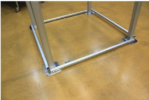
柱開き止めフレーム組立完成写真
