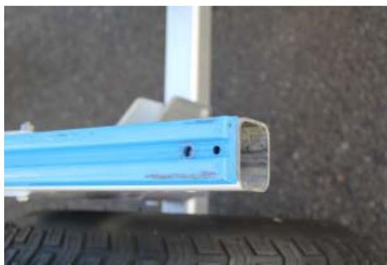
ジェットランチャーのレールフレームの黒いエンドキャップを留めてるリベットとレール材を留めてるすぐ横のリベットをドリル等で外します。
