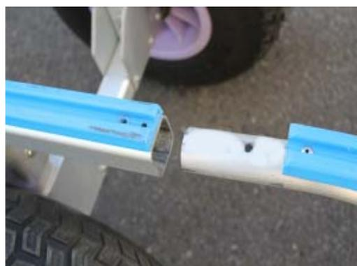
レールフレームにレールエンドフレームを差し込みます。
