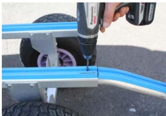
レールを留めていたリベット穴（端から2個目）をドリルで6.2mmに開け直します。
