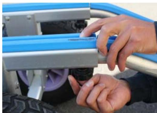
開け直した穴に付属のM6ボルトを入れノットで固定します。
