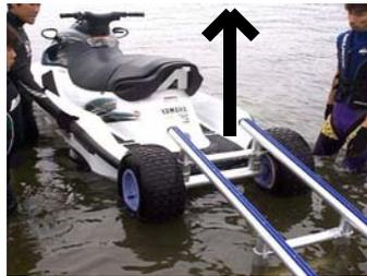
●ジェットを水に降ろすとき、ジェットランチャーがタイヤの浮力の反動で飛び出してくる恐れがありますので注意してください。
