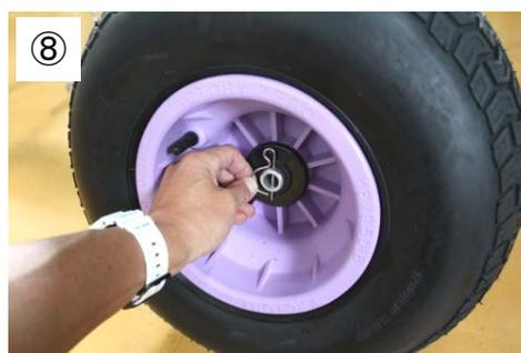
最後にタイヤを⑧車軸シャフトの丸棒に差し込み⑪リングを⑧車軸シャフトの穴に差し込んで完成です。
