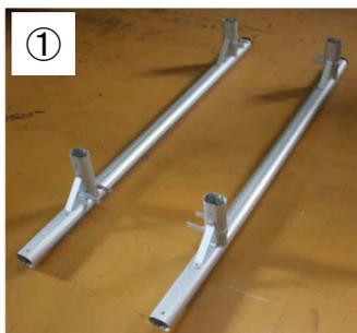
③-1、③-2、メインフレームセットの青いレール部を下にし楕円70x50°ラケットが内側の向きに写真のように位置します。
