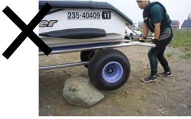
●段差のきつい所での走行や内輪差による後輪の衝突などに注意してください、破損の原因になります。
