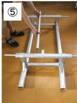
車軸フレーム前後にある⑤-A楕円ラケットストレート連結固定30mmの間に⑤センターフレーム1020mmをボルトで固定します。車軸フレームのセンターに位置します。
