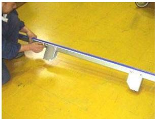
**A** レールフレームにジョイントブラケットBをトラスビスでナマカット部が内側の向きに2個取付ます。完成時トラスビスが外側の向きになります。
