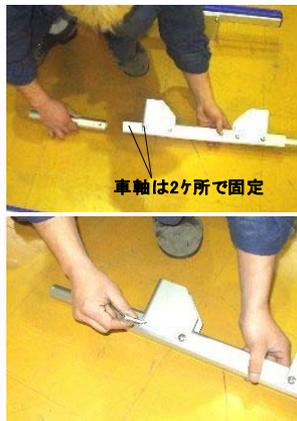
フットパイプにジョイントブラケットAを写真の向きにかぶせ先ほどの車軸シャフトをカラー側からフットパイプに差しジョイントブラケットA、フットパイプの穴を合わせトラスビスM6-52、外側はM6-45で取付。完成時トラスビスが外側の向きになります。
