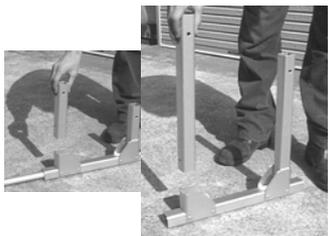
**C** フットパイプにスタンドパイプ400mmを差込、車軸フレームを組んだフットパイプにスタンドパイプ200mmを差込みM8ボルト類で固定します。
