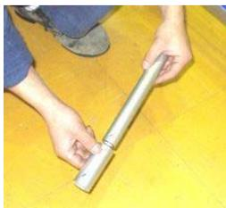
**B** 車軸シャフトに車軸シャフトカラーをかぶせM6ボルト用の穴を合わせます。
