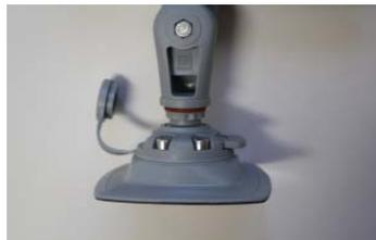
ロッドホルダーの根元にある赤いラインが消えるまで差し込みマウントレバーを横に押ししっかりロックしてください。
