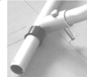
車軸フレームにシャフトカラーを入れタイヤを入れてDリングで止めます。
