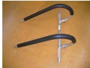
曲げフレームと車軸フレームをピンと松葉ピンで固定します
