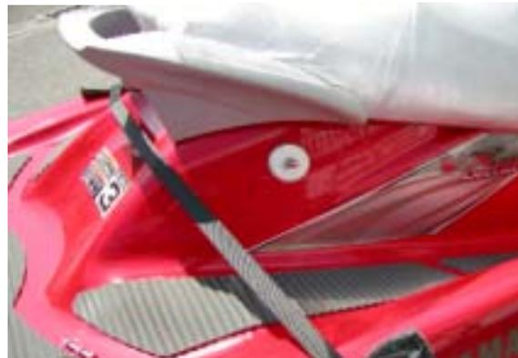
メインパイプを仮立ててみてが前後左右垂直に立っている位置でのサイドパイプ先端の位置を決めます（およそ写真の位置です）マーキングをしてドリルにて穴開けしパーツを取付ます。
